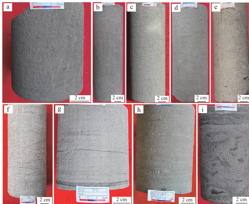
图2 富县地区长7—长9油层组砂质碎屑流沉积典型岩心照片(a—d,i图引自文献[31])
