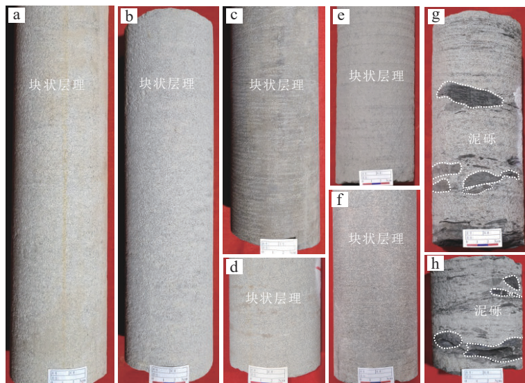
图2 鄂尔多斯盆地志丹地区长8—长9油层组砂质碎屑流沉积典型井岩心照片
