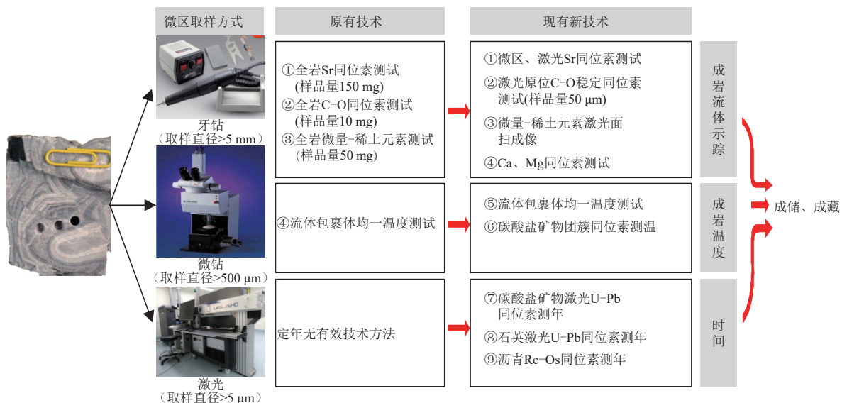
图3 以定年、定温、定流体属性为核心的微区多参数检测技术
