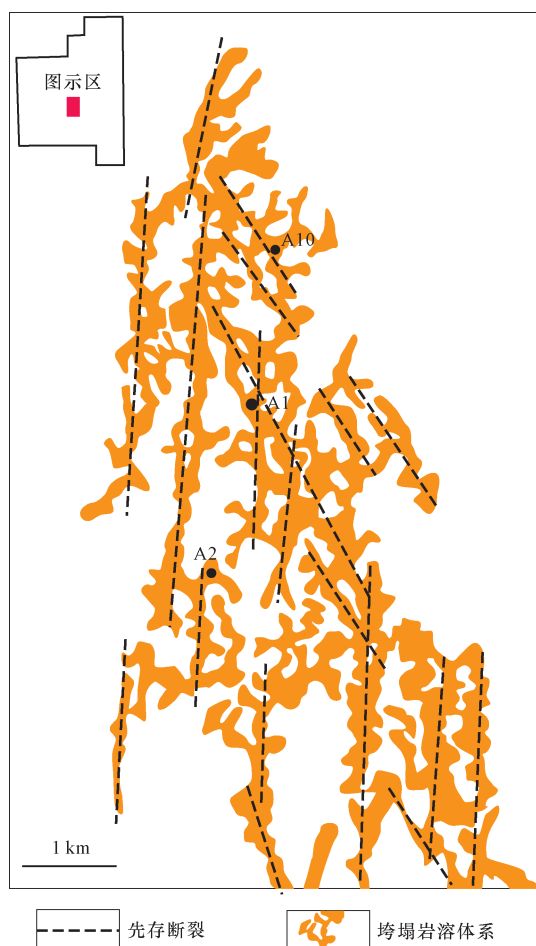
图12 塔里木盆地哈拉哈塘油田区4岩溶洞穴系统与可能的先存断裂关系
