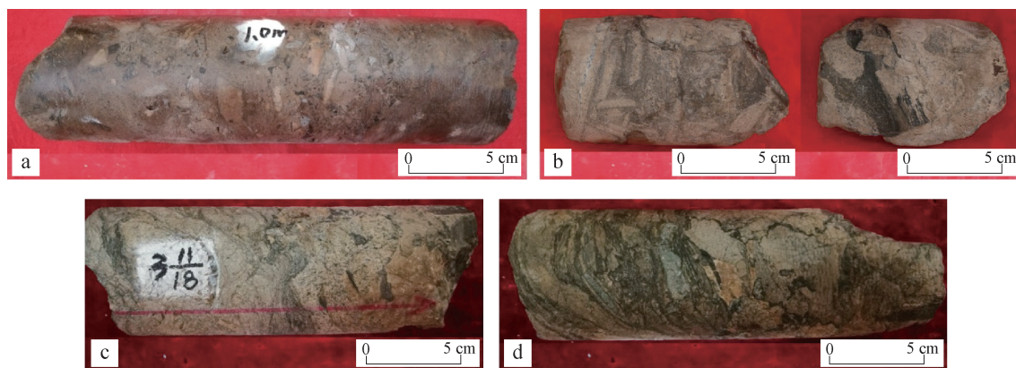
图6 塔河油田塔深6井蓬莱坝组典型砾屑白云岩(a,b)和滑塌沉积构造(c,d)岩心照片
