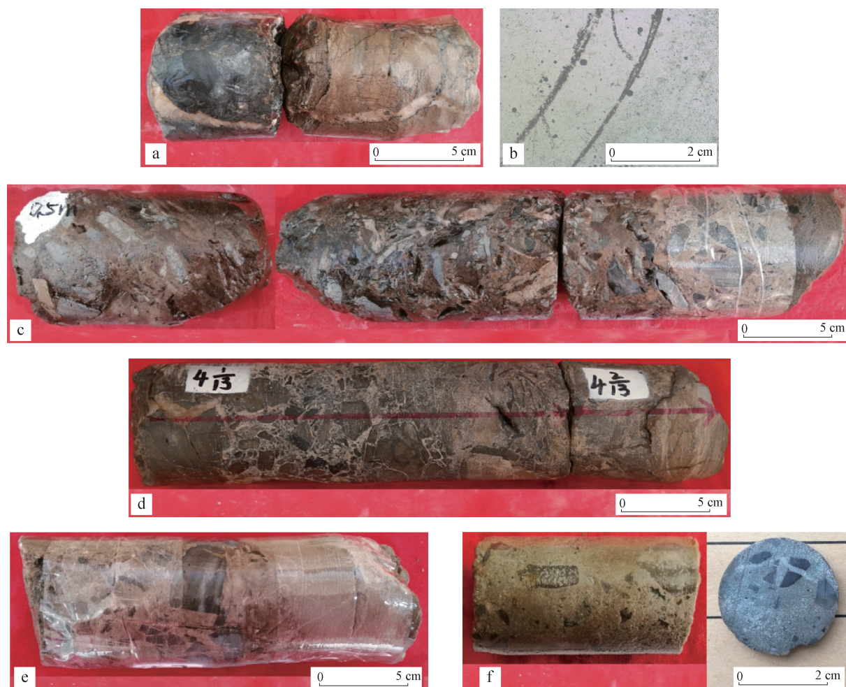
图4 塔河油田塔深6井蓬莱坝组典型硅质团块(a,b)和角砾状硅质岩(c—f)岩心照片及岩石薄片照片
