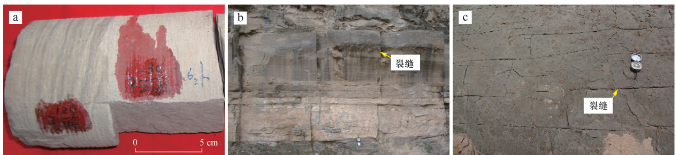
图1 安塞油田长6储层岩心及延河露头裂缝特征
