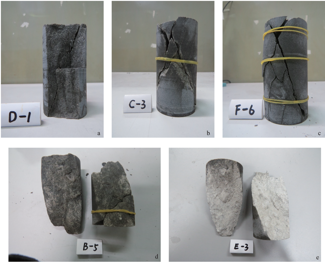
图 3 典型试样破裂面 Fig. 3 Typical fracture surface of the samples
