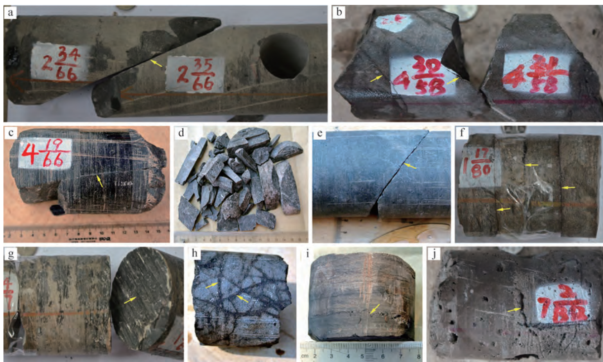
图2 彭州地区雷口坡组储层岩心裂缝特征
