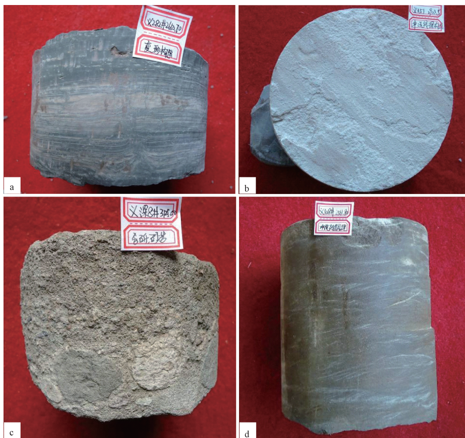
图2 渤南洼陷岩心中典型沉积构造
