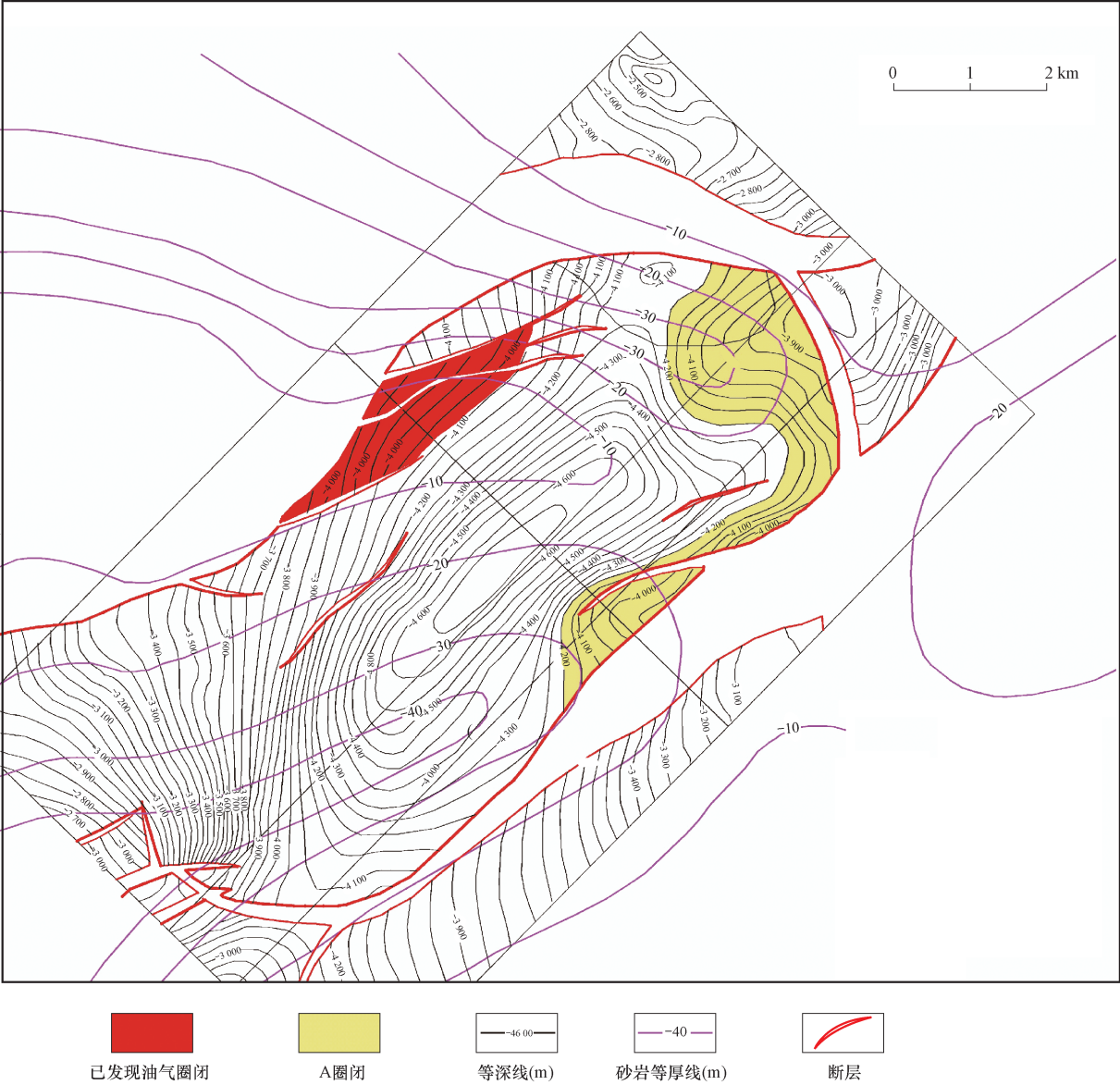
图 3 圈闭 A 沙三中 5-6 砂组砂岩厚度与圈闭叠合图
