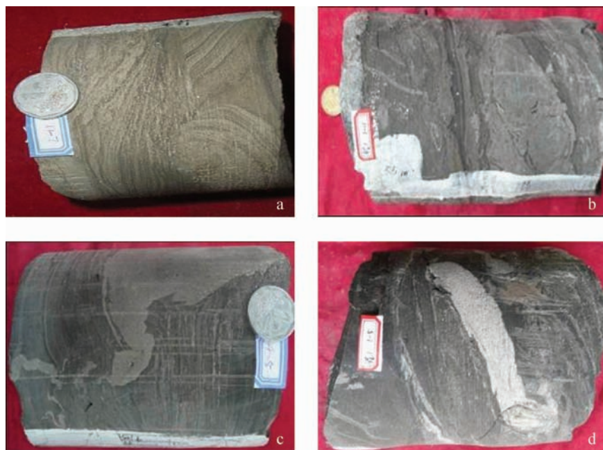
图3 泌阳凹陷滑塌浊积扇岩心特征
