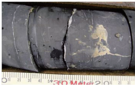
a.长芯1井岩心, S 1 l, 黑色页岩, 网格状裂缝
