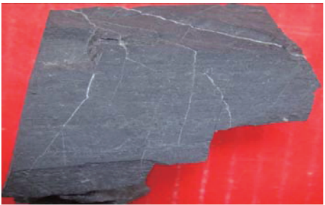
b.城口石溪河剖面, C 1 q, 黑色页岩, 细微网格状裂缝
