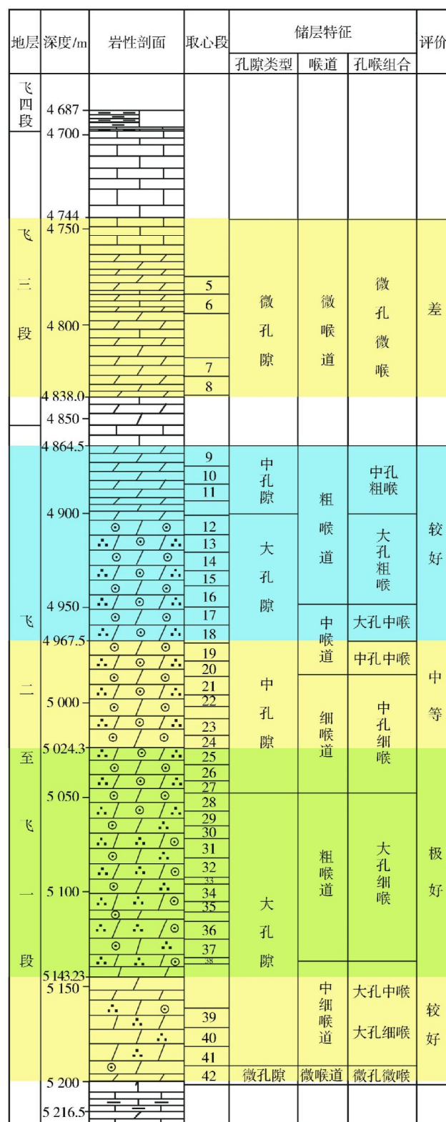
图 6 川东北地区普光气田飞仙关鲕滩储层特征图
