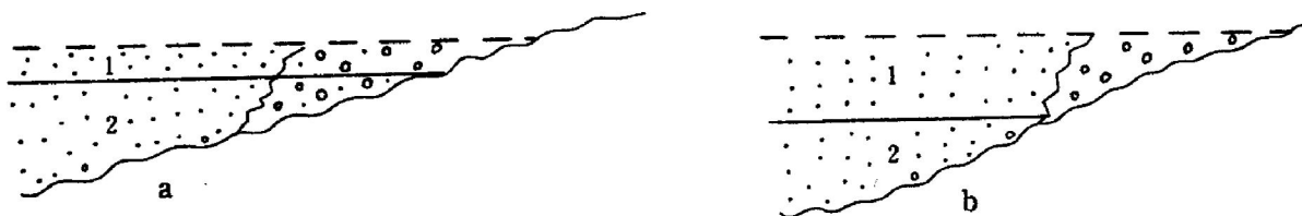
图6 古城鼻隆边缘东河砂岩不同岩性超覆成因示意图
