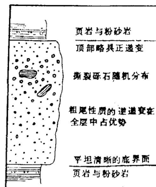
图8 颗粒流沉积的层序模式
